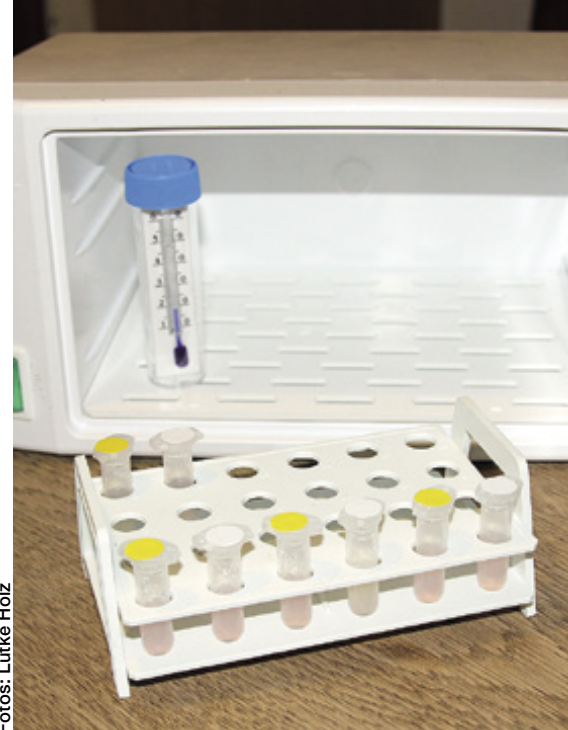
Milch in zwei Röhrchen füllen, nach 12 bis 14 Stunden steht das Ergebnis fest.
